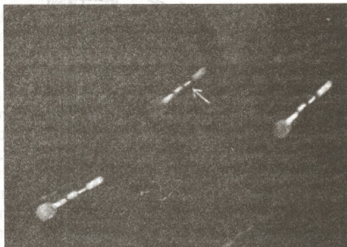
Опит за фокусиране на обектив. Следата, маркирана със стрелка, показва доброто фокусиране.
